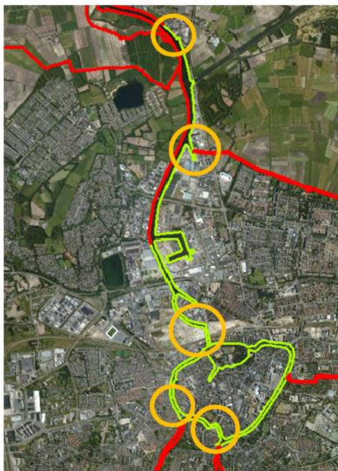
Figuur 3-4. Knelpunten in en rond de stad Breda. De drie zuidelijke punten zijn knelpunten met een beperkte afvoercapaciteit. De twee noordelijke punten zijn laag liggende gebieden die relatief snel onderlopen bij hoge waterstanden in de MDV boezem (Versteeg et al., 2013).
