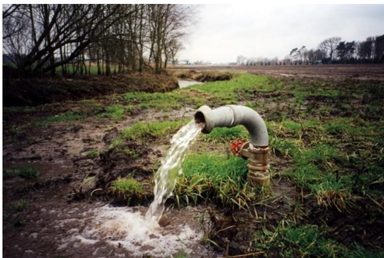
Figuur 2-19 Artesische bron langs de Strijbeek. Doordat de stijghoogte boven het maaiveld uitkomt, stroomt het grondwater bij het opendraaien van de buis vanzelf omhoog (De Louw et al., 2000).
